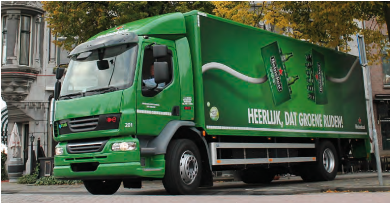
De zwaarste elektrische vrachtauto van Europa met een netto laadvermogen van ruim 9 ton en een actieradius tot 200 kilometer.
