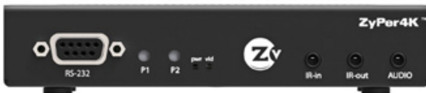
ZyPer 4K, kan 4k beelden ongecomprimeerd over IP sturen
