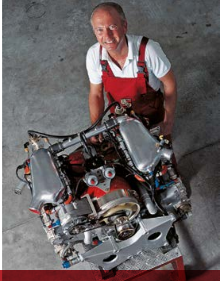
Oude meester: Kremer-motorchef Walter Heuser met een aggregaat van Groep A – op de voorgrond is het kleine schoepenwiel voor de koeling van cilinders en motorcarter goed te herkennen.
